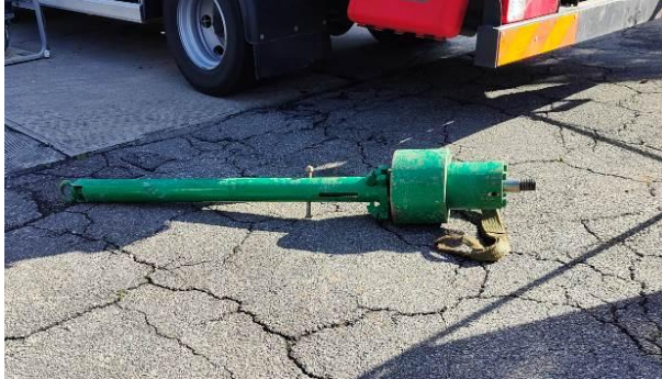
Attrezzatura prova SPT
