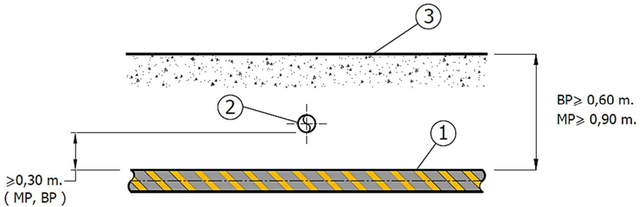
Protezioni : Sottopasso di tubazione acqua ,  $d < 0,30$  m.
