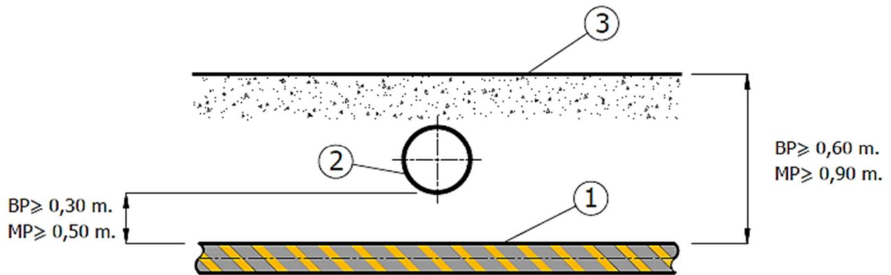
Protezioni : sottopasso fognature tubazioni gas BP - MP , d < 0,50 m.(MP), d < 0,30 m.(BP)
