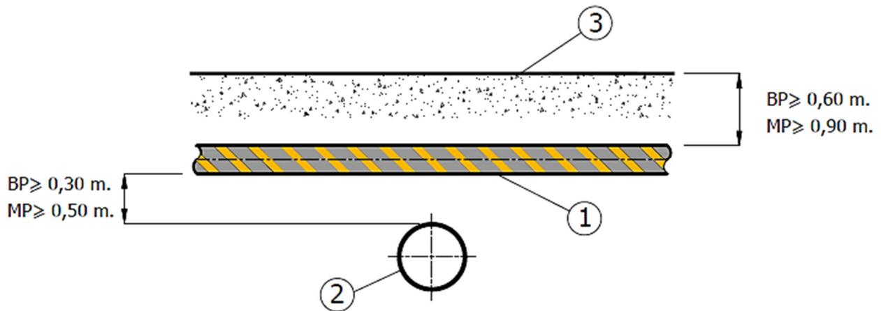
Protezioni : sovrappasso fognatura tubazione gas MP , d < 0,50 m
