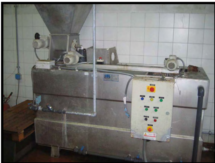
15 Preparazione polielettroliti
