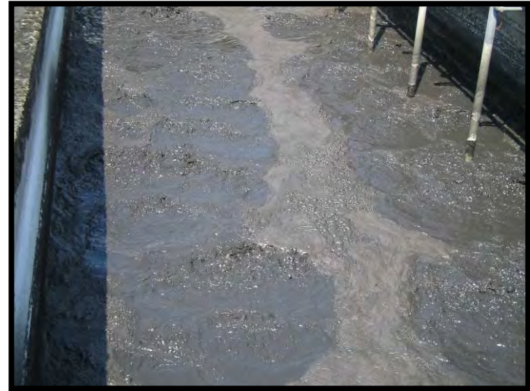
10 Digestione aerobica e ispessimento batch
