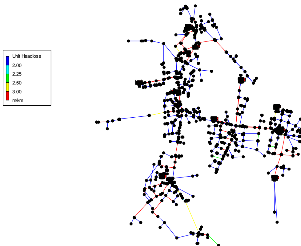
Figura 6 - Individuazione delle condotte con perdite di carico unitarie > 3 m/km di rete
