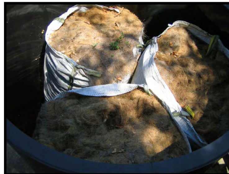
20 Materiale biofiltro non utilizzato
